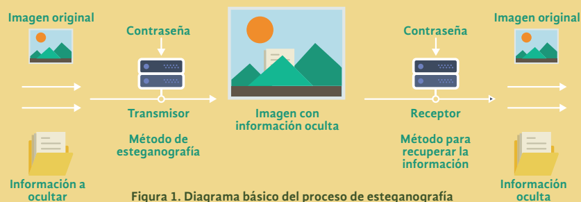
Figura 1. Diagrama básico del proceso de esteganografía mediante imágenes.
